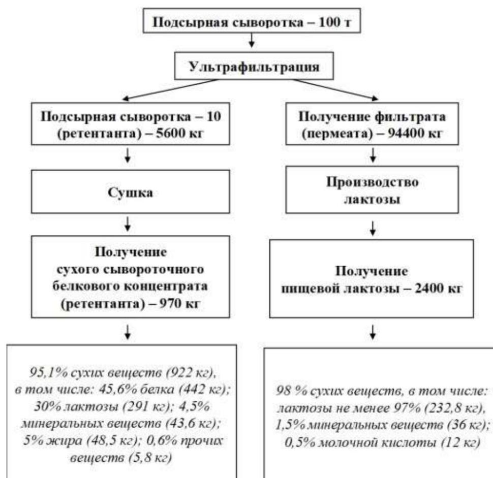
**Рисунок 5.** Логистическая схема ультрафильтрации подсырной сыворотки
