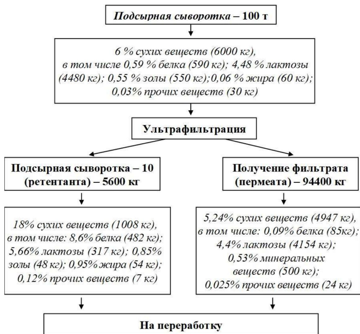
**Рисунок 4.** Схема ультрафильтрационного разделения молочной сыворотки
