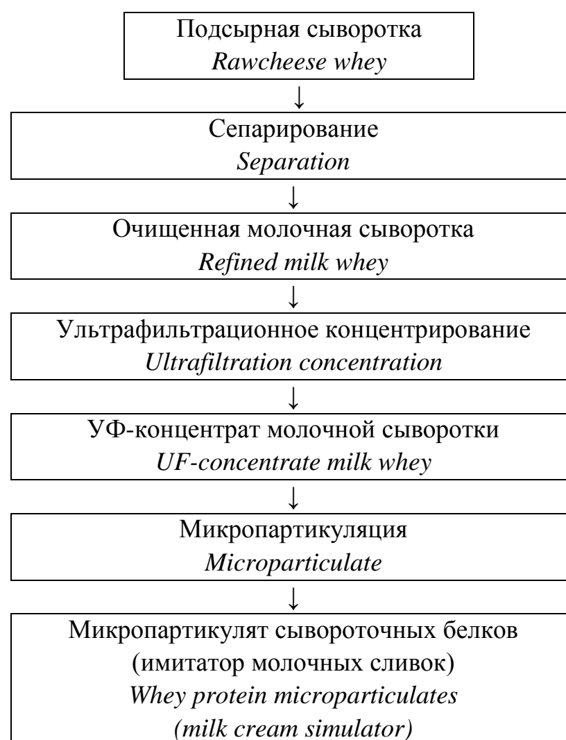
Рисунок 5 – Последовательность технологических операций микропартикуляции Figure 5 – Sequence of technological operations of microparticulation
