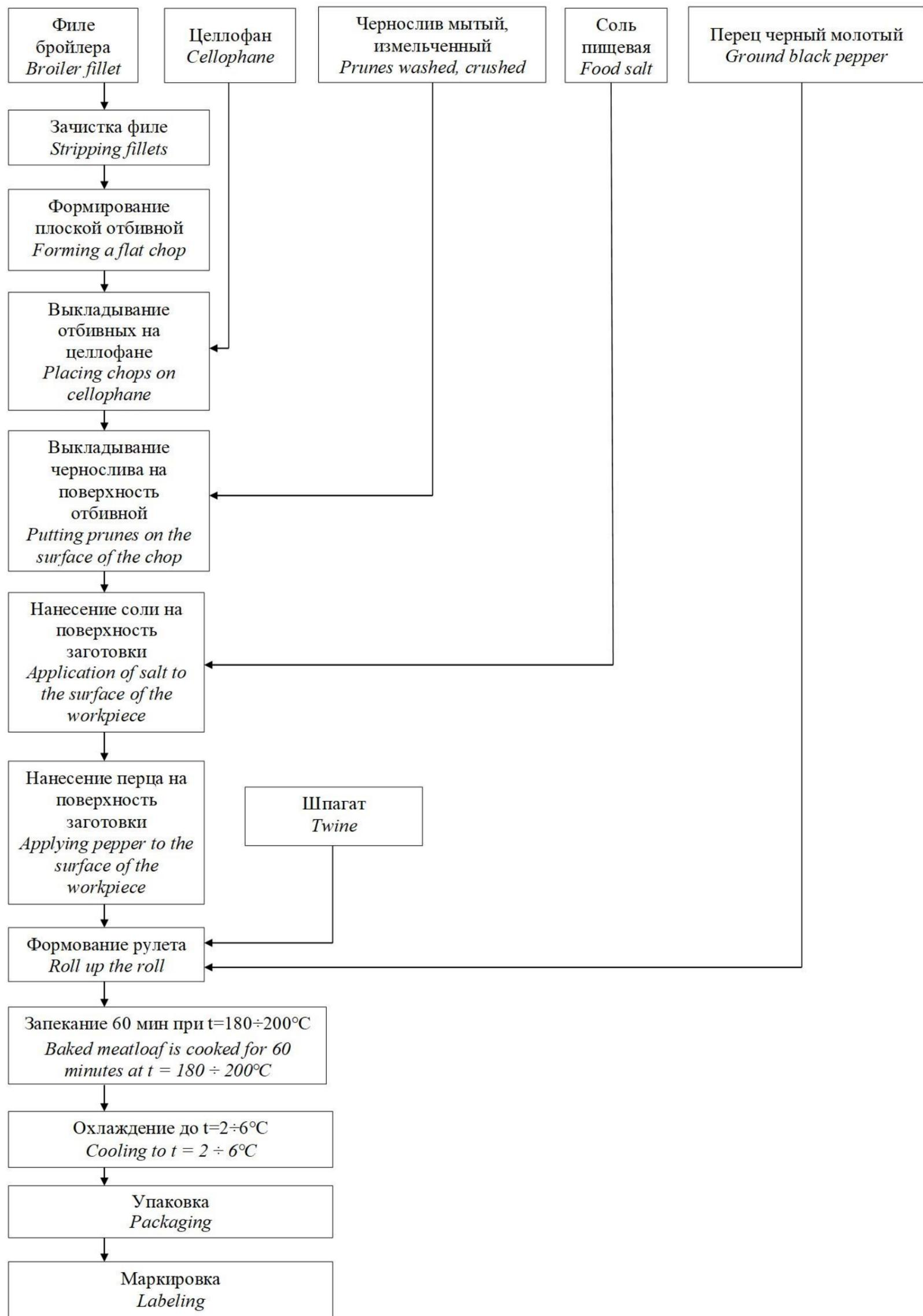
**Рисунок 1.** Технологическая схема производства запеченного куриного рулета с черносливом
