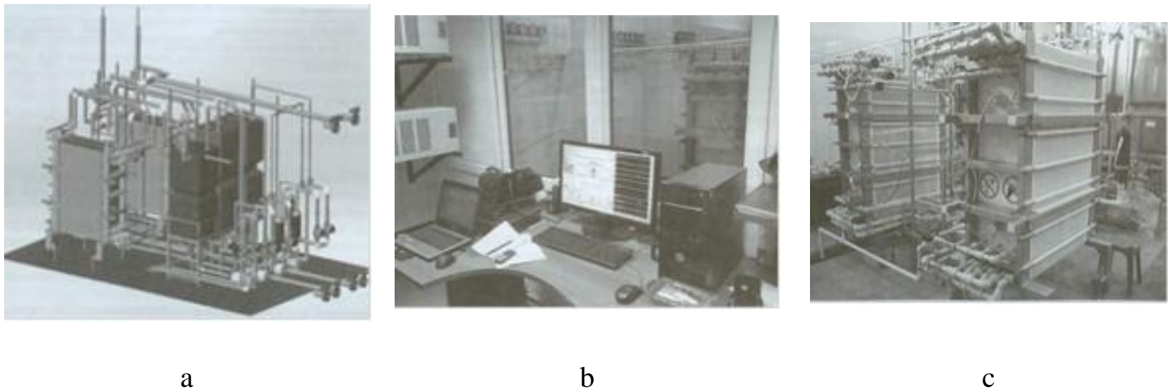
Рисунок 2: а – схема компоновки двухмодульной ЭДУ; б – система управления ЭДУ; с – общий вид электродиализных модулей (ООО «Инновационное предприятие «Щёкиноазот») Figure 2: a – layout diagram of a two-module EDU; b – control system of EMU; c – General view of electro dialysis modules (LLC «Innovative enterprise «Shchekinoazot»)
