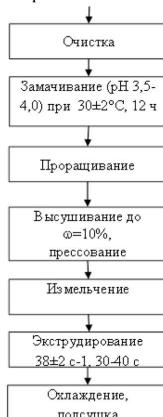
Рисунок 5 – Схема производства нугово-тыквенного экструдата
